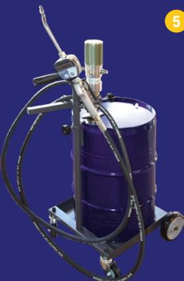
Für die Verteilung von Ölen mittlerer und hoher Viskosität. Doppelwirkende Pumpe 3:1, Fassverschraubung, Fahrwagen, digitaler Handdurchlaufzähler mit Drehgelenk.
