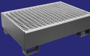
Auffangwanne zur Lagerung von wassergefährdenden und entzündlichen Flüssigkeiten. Gefertigt aus 3 mm Stahlblech, mit Bauartzulassung und Prüfzeichen gemäß StaWaR. Herausnehmbarer, feuerverzinkter Gitterrost mit Platz für 2 x 208-Ltr.-Fässer.
