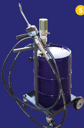
Für die Verteilung von Ölen mittlerer und hoher Viskosität. Doppelwirkende Pumpe 3:1, Fassverschraubung, Fahrwagen, digitaler Handdurchlaufzähler mit Drehgelenk.
